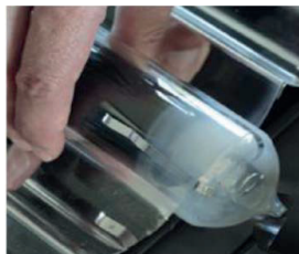
газопоглинач зруйнований, трубка несправна
